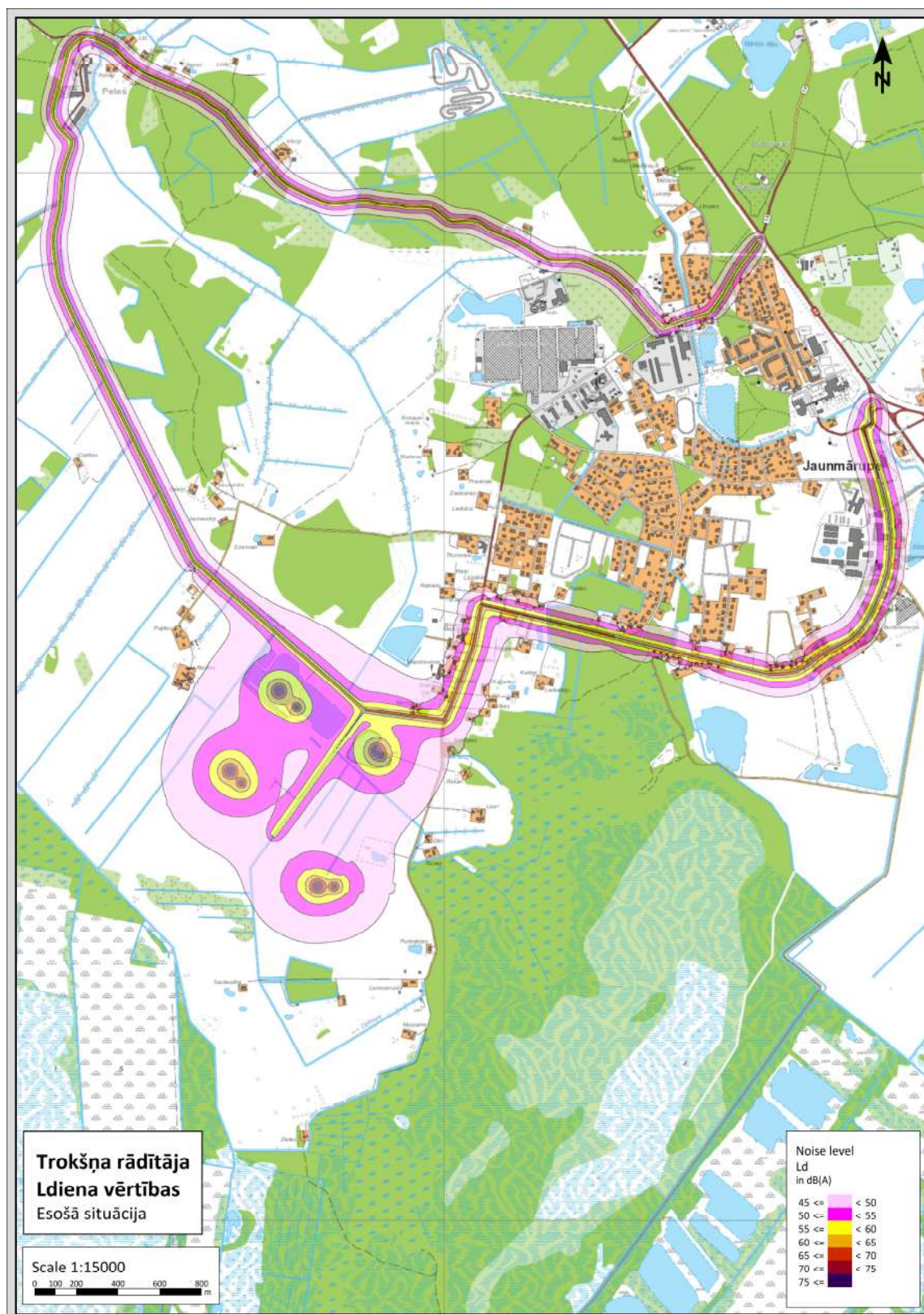
Attēls Nr.21 Esošais troksņa līmenis un tā izplatība paredzētās darbības un tai pieguļošajās teritorijās un smilts materiāla transportēšanas maršrutā (Avots: SIA “Vides eksperti”)
