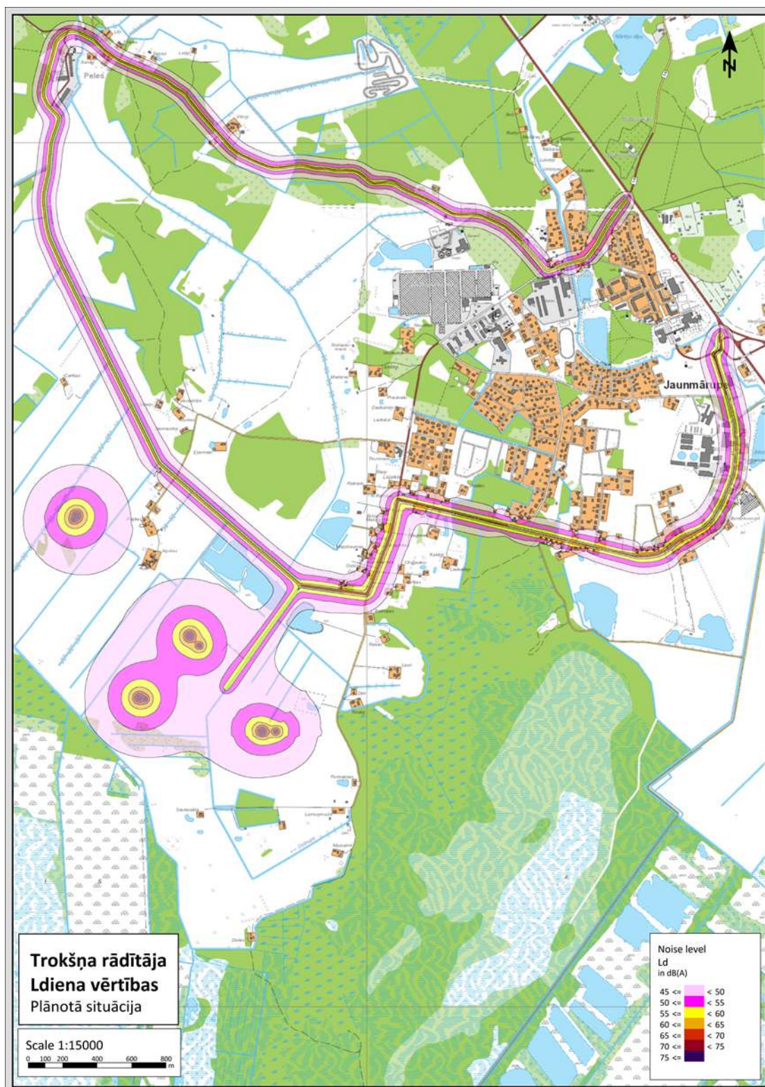
Attēls Nr.23 Prognozētais trokšņa līmenis un trokšņa izplatība paredzētās darbības īstenošanas procesā, smilts materiāla izrakšanas un transportēšanas laikā (Avots: SIA “Vides eksperti”)
