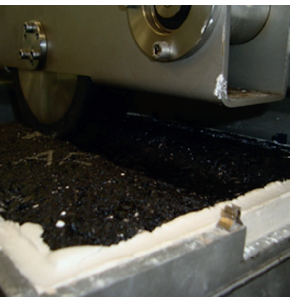
8. un 9. att. Riteņu sliežu tests (9. attēlā pa kreisi paraugs ar ģeokompozītu, pa labi – bez).
