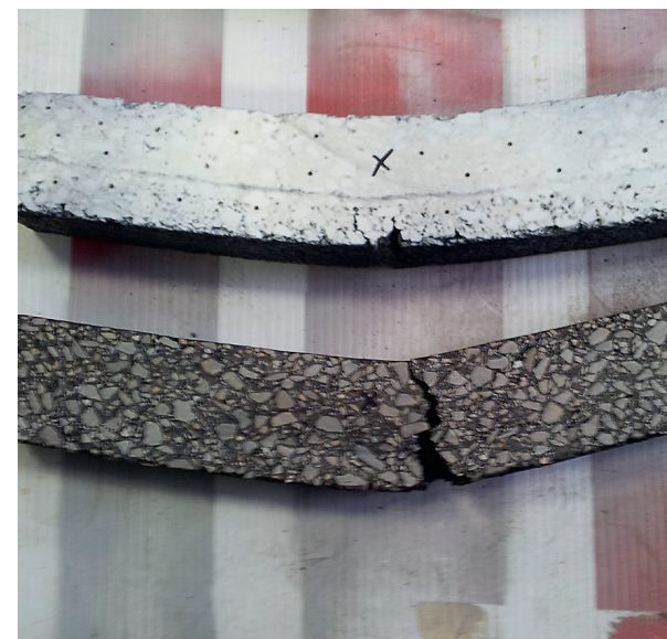
6. att. Paraugs ar ģeokompozītu pēc 6000 cikliem (baltais) un bez ģeokompozīta pēc 2500 cikliem.
